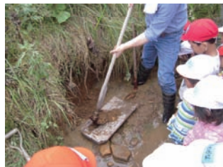
「カッチャ」 川底の土砂を掬い上げる道具
